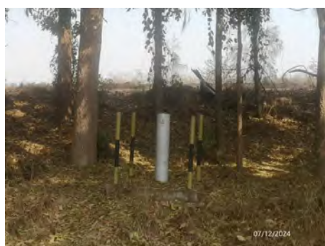
ภาพที่ 2.2-29 บ่อสังเกตการณ์ (Monitoring Well)
